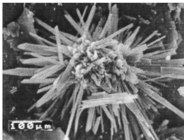
Obr.6. Sekundárny produkt biooxidácie arzenopyritu v karbonatickej hornine - sádrovec.
