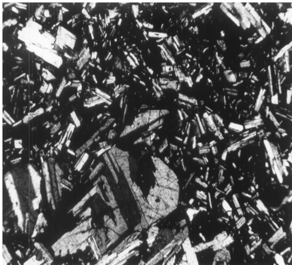
Obr.1. Hyperstenicko-augitický andezit Ruskov. Porfyrická štruktúra s pilotaxickou štruktúrou základnej hmoty. Polaroidy X
