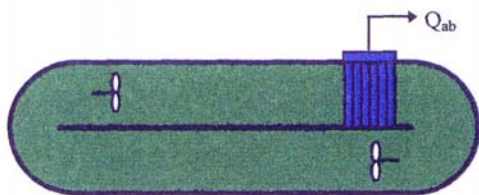
Abb.6. Anordnung von Lamellen in Umlaufbecken.
