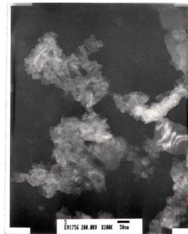
Obr. 6. RTG snímky mechanochemicky syntetizovaných CuS nanočastíc, 1-CuS-kovelín, 2- \text{CuSO}_4 \cdot 5\text{H}_2\text{O} -chalkantit, 3- \text{CuSO}_4 \cdot 3\text{H}_2\text{O} -bonatit (A) a TEM mechanochemicky syntetizovaných CuS nanočastíc (B)
