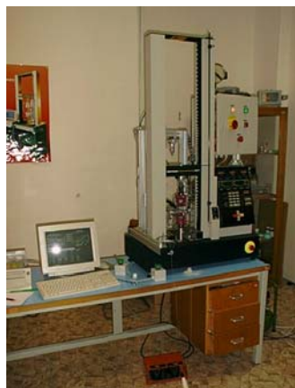
Obr. 3. Univerzálny trhací stroj INSTRON 4411 [7] Fig. 3. Universal ripper machine INSTRON 4411
