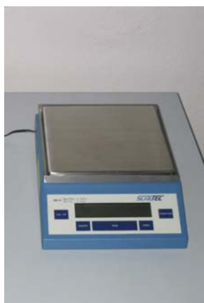
Obr. 2. Laboratórne váhy SBC 51 [7] Fig. 2. Laboratory scale SBC 51
