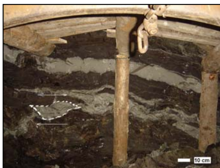
Foto 1. Čelba banského diela 108 171-15 Baňa Nováky, o.z. (na fotodokumentácii vidieť, že svetlý íl nadobúda charakter duktilných dutín). Photo 1. Face of the mining working 108 171-15 Baňa Nováky, o.z. (see the light clay getting a character of ductil alarm clock).
