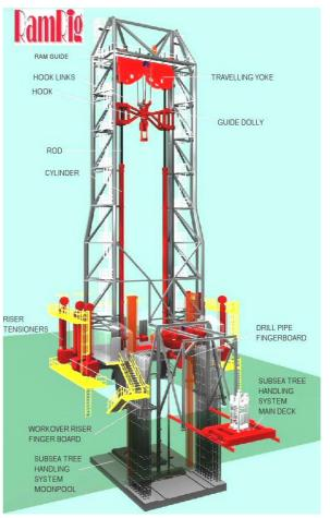
Fig. 2. RamRig<sup>©</sup> new rig offshore concept.
