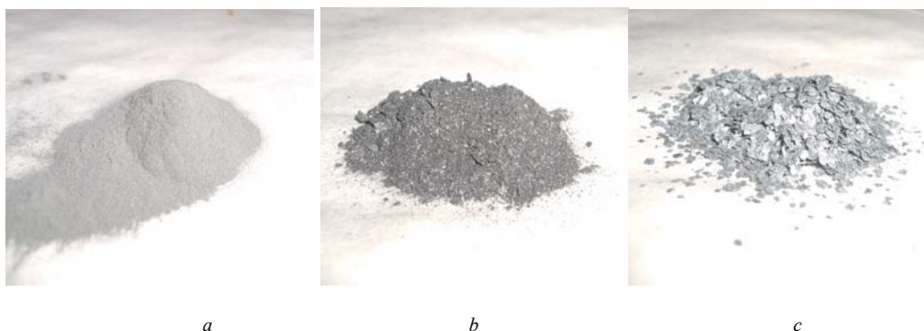
Obr. 2. Fotografie použitých vzoriek: a – zink bez mechanickej aktivácie, b – mechanická aktivácia v metanole ( t = 60 \text{ min} ), c – mechanická aktivácia v butanole ( t = 60 \text{ min} ).
