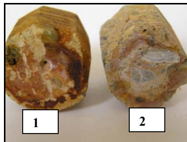
Obr. 1. Biokorózia vzoriek betónu vplyvom baktérií Acidithiobacillus ferrooxidans 1 - Acidithiobacillus ferrooxidans 2 – abiotická kontrola
