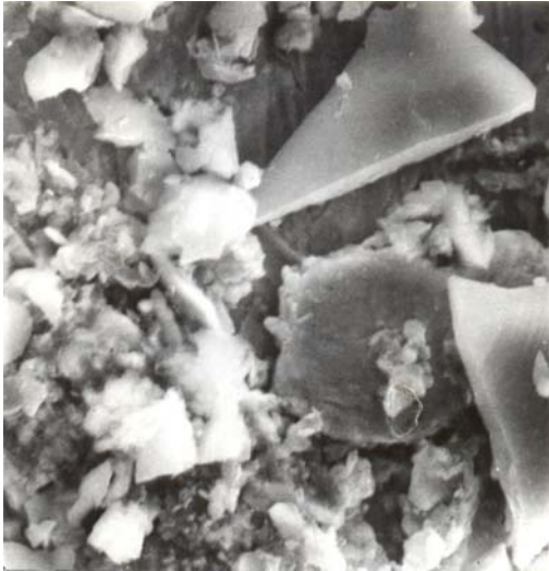
Obr. 3. Reálny banský prach. Zväčšenie 5000 x. Fig. 3. The real mining dust. Magnification 5000 x.
