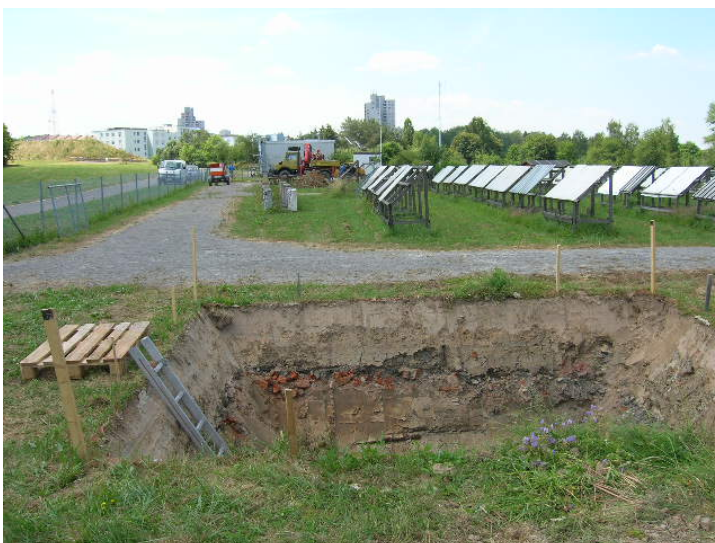
Abb. 8. Das Testgelände der Materialprüfanstalt Baden-Württemberg in Stuttgart-Vaihingen. Für das Forschungsprojekt „Erdwärme“ der Landesstiftung Baden-Württemberg wurde ein bestehendes Testfeld für Gebäude-Fassadenelemente horizontal unterbohrt.
