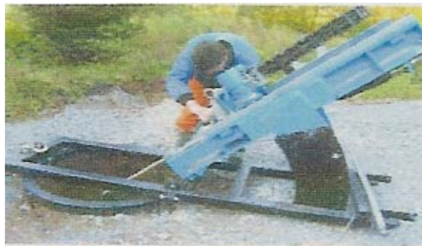
Abb. 18. Einstellung des Neigungswinkel bis 60°. Fig. 18. Setup of the machine to the 60° angle.
