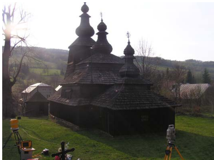
Obr. 3. Zameranie polohy TLS pomocou GTS. Abb. 3. Die Positionabsteckung des TLS mit dem GTS.
