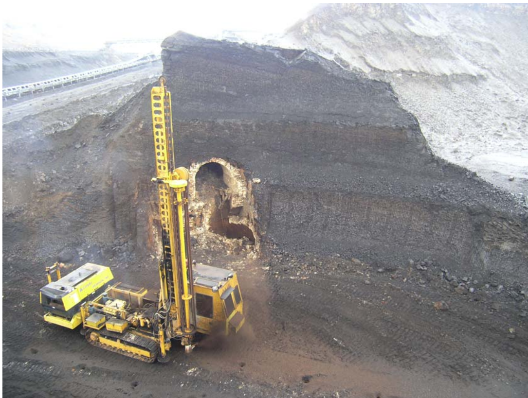
Obr. 15. Vrtná souprava při předvrtávání – v pozadí „Rizikové místo“ – Hlubinný zásobník. Fig. 15. Drilling rig at work during test boring “– the risk places” in a background – the deep reservoir.
