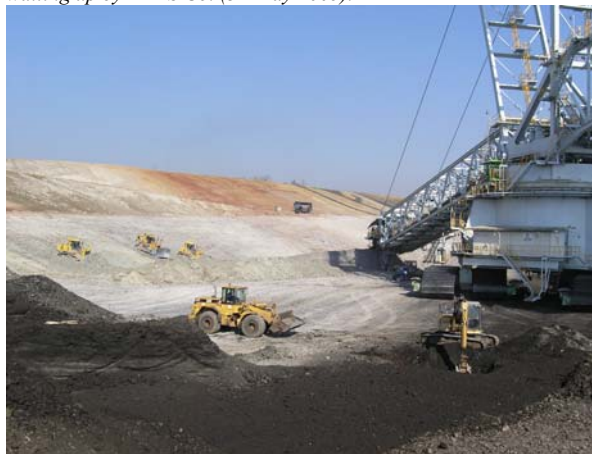
Obr. 20. Tvarování závěrných svahů – rypadlo SchRs 1550 ve smíšeném řezu, likvidace DD.
