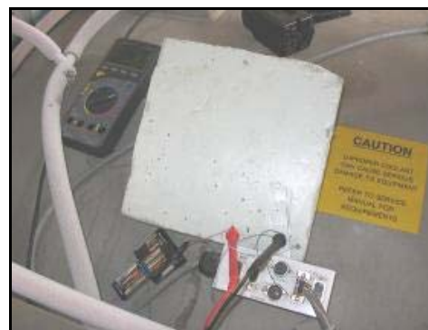
Obr. 8. Realizovaný prípravok na meranie vnútornej teploty kryostatu.
