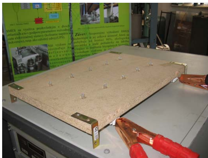
Obr. 1. Testovacia zát'áž pre supravodivý magnet.
