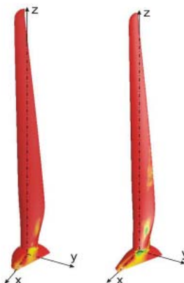
Fig. 3. Zobrazenie šmykového napätia pri rýchlosti 7 a 10,5 m/s (kladné je zobrazené červenou, záporné predstavujú miesta separácie prúdu).
